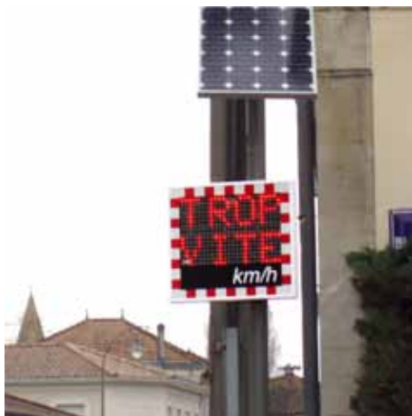
Le radar pédagogique ne se contente pas de donner la vitesse. Il indique au conducteur, en cas de dépassement, qu'il roule « trop vite ».
