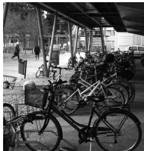
Stationnement des vélos sur le site de Carreire. Des accroche-roue évidemment. Les cyclistes cherchent tant bien que mal à y attacher leur cadre ou vont ailleurs à la recherche de barrières accueillantes.
