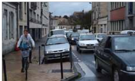
Rue Vilaris, un axe structurant reliant le quartier Nansouty et la gare Saint-Jean. L'espace accordé à la voiture est comme souvent démesuré : deux files de circulation et deux files de stationnement. Les cyclistes se faufilent entre les voitures, frôlant l'asphyxie aux gaz d'échappement, ou utilisent les trottoirs. En supprimant une file de stationnement il serait pourtant facile de créer une piste cyclable.
