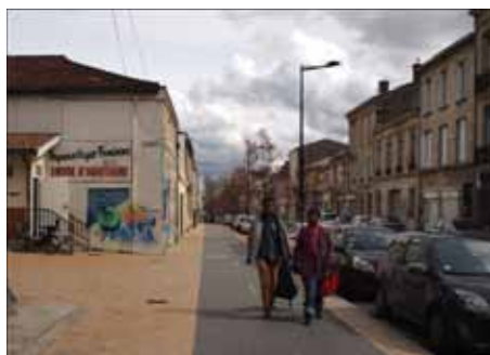
Rue des Douves. La bande cyclable prend la quasi totalité du trottoir, laissant peu d'espace aux piétons qui « débordent » sur l'espace cyclable. Les deux files de stationnement et de circulation pour les voitures ont été conservées.
